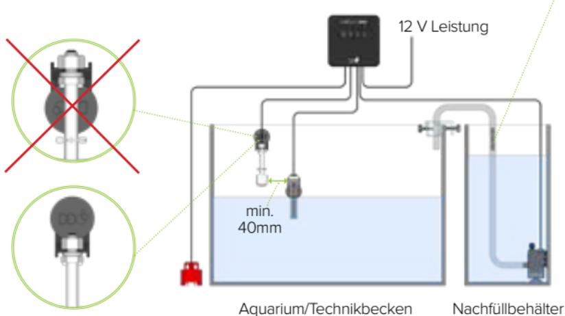
Der Advanced ATO Controller muss an einem geeigneten Ort befestigt werden, der von Spritzwasser und Bereichen mit hoher Luftfeuchtigkeit geschützt ist. Er sollte nicht direkt über offenem Wasser montiert werden. Schließen Sie das ATO-Gerät nicht an die Stromversorgung an, bevor die Einrichtung abgeschlossen ist.
