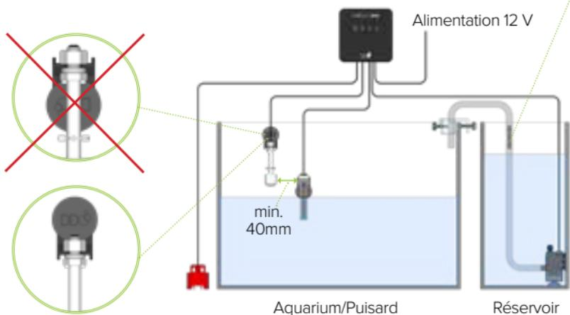
Le Advanced ATO Controller doit être fixé dans un endroit approprié, à l'abri d'éclaboussures et des zones à forte humidité. Il ne doit pas être monté directement au-dessus de l'eau libre. Ne branchez pas l'unité ATO sur le secteur avant d'avoir terminé l'installation.
